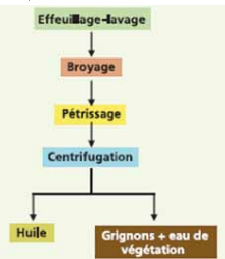
Système continu d'extraction avec centrifugation à deux phases
