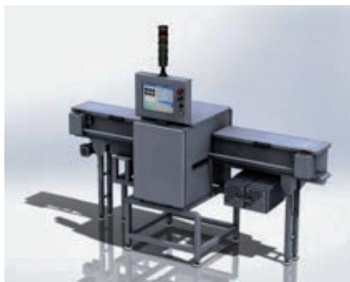
Nouvelle machine Rayons-X en vue de côté (boîtes, flacons en plastique, ...)
