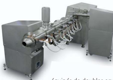
Le principe du projet CRISTAL (pétrin continu sous vide) est un mélangeur à double arbres tournant dans des corps
