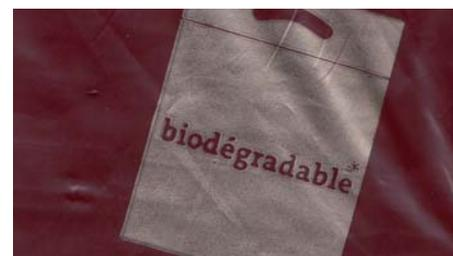
polyéthylène. Cet agent est un sel de métal de transition, le cobalt. Utilisé à de très faibles concentrations, il n'est pas nocif, et va modifier le comportement du plastique pour le rendre oxo-biodégradable, soit une décomposition plus rapide de la structure chimique du plastique.
