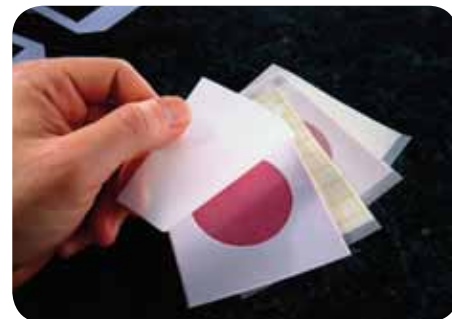
Petrifilms : Tests microbiologiques PAE déshydratés (ISO 16140)
