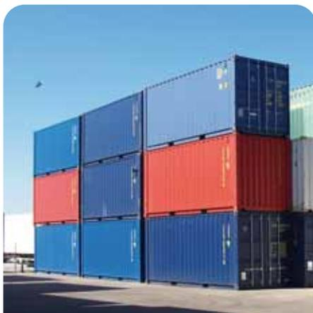
horizontales pour former l'armature de la caisse proprement dite. Ces cadres sont extrêmement robustes car ils doivent pouvoir supporter le poids de cinq autres containers posés par-dessus, soit une masse de plus de 150 tonnes, appuyée uniquement sur les quatre coins du container. Le cadre avant comme les parois latérales et le toit sont fermés par une tôle ondulée qui participe à la rigidité de l'ensemble. Le toit doit pouvoir supporter une charge de 300 kg sur une surface de 600 x 300 mm sans
