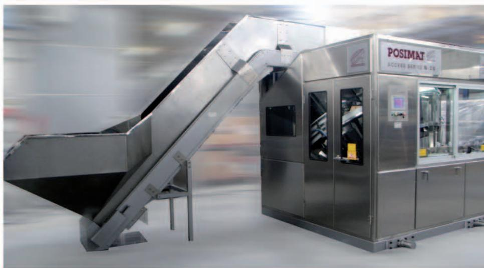
*Redresseur de bouteilles en plastique, d'une grande simplicité de fonctionnement, efficace, et qui ne nécessite pratiquement aucun entretien. Convient à une grande variété de formes et de tailles de bouteilles. Changement de format simplement en branchant et débranchant les nouveaux sélecteurs/ entonnoirs du format à positionner, sans recourir à des outils (sans outillages ni réglages). Ces changements de format peuvent être réalisés facilement par un opérateur de ligne en peu de temps.*
