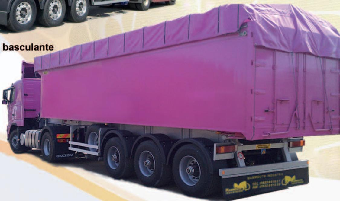
**S/R Benne bâchée en aluminium lisse**
