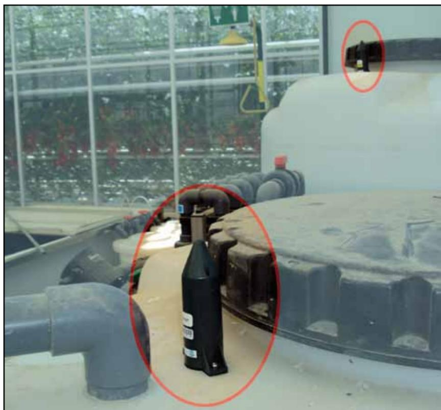
est impossible d'immerger des appareils de mesure, et seul un contrôle visuel extérieur permet d'estimer le volume restant dans les cuves. Et ce contrôle doit être régulièrement réalisé pour éviter les désagréables ruptures de stock.
