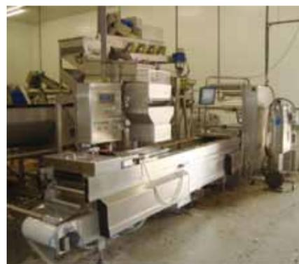
place, un contact est activé et le produit se déverse dans le sac. L'opérateur positionne alors le sac rempli sur une machine d'emballage à double plateaux pour un conditionnement sous vide ou sous atmosphère modifiée suivi de la soudure du sac. Le produit conditionné est positionné sur palette (cas de l'emballage sous vide) ou posé dans une caisse en carton (cas de l'emballage sous atmosphère modifiée).
