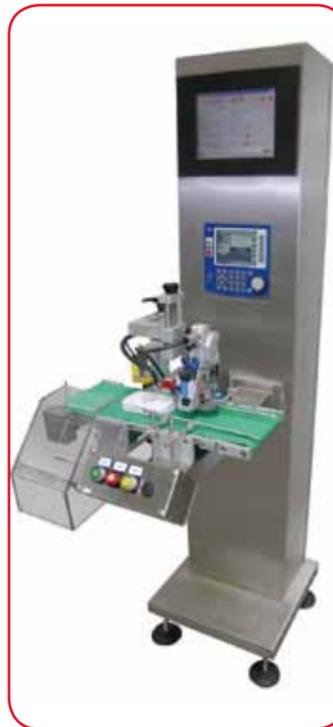
La société italienne *CICRESPI*, spécialisée dans les systèmes d'impression et de marquage, commercialise un système complet constitué de l'impression par jet d'encre, de la vérification et de l'enregistrement informatisé de codes *Datamatrix*, d'une capacité jusqu'à 200 boîtes de médicaments par heure.
