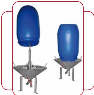
Apsis Technologies a mis au point Wash-Ti, un équipement qui permet de laver les fûts ou autres contenants. L'équipement, en inox, est facile à implanter et à utiliser. Il est raccordé à un réseau d'eau et à une vidange. Ainsi, la tête de lavage est coiffée avec le contenant. L'on appuie manuellement sur le contenant pour activer la tête de lavage à 360°. Dès que le contenant est retiré, le lavage s'arrête.
