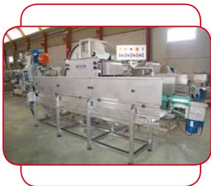
La société Maquinaria Conservera Tomas Guillen SL a un nouveau modèle Universal, conçu pour remplir tous les formats de boîtes métalliques et bocal en permettant un ajustement du remplissage en hauteur et en largeur. Cette machine est adéquate pour la mise, en boîte ou en bocal, de divers produits, tels que les olives, câpres, cornichons, fruits en morceaux, tomates pelées.
